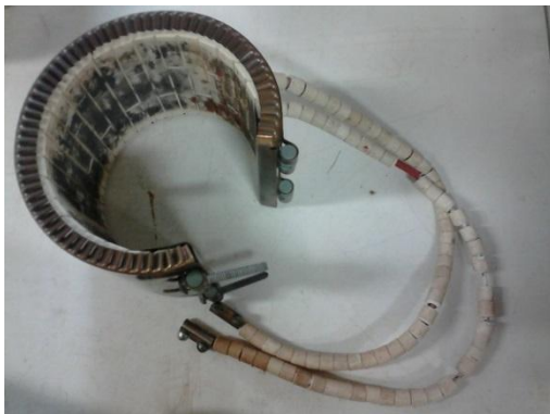
Figura 9 - Resistência colocada na camisa utilizada na ignição do óleo
