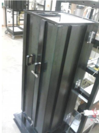
Figura 10 - Caixa de aço que reveste o tubo e a jaqueta
