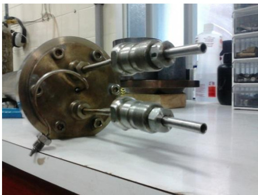
Figura 5 - Tubo de combustão com os tubos guia onde são colocadas as sondas fixa e móvel.
