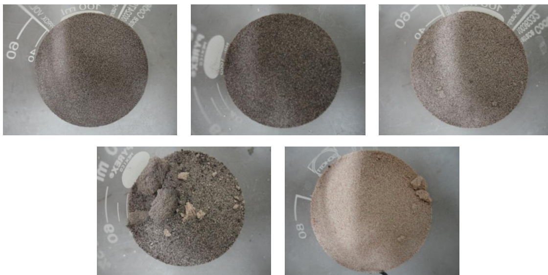
Figura 34 - Amostras da mistura após a combustão - Em cima: a 10 centímetros da base do tubo (à esquerda); a 30 centímetros da base (ao centro); a 50 centímetros da base (à direita). Em baixo: a 70 centímetros da base (à esquerda) a 90 centímetros da base (à direita) - ETCIS-4 (TI 3.8 L/min)
