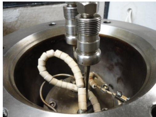
Figura 9 - Resistência colocada na camisa utilizada na ignição do óleo
