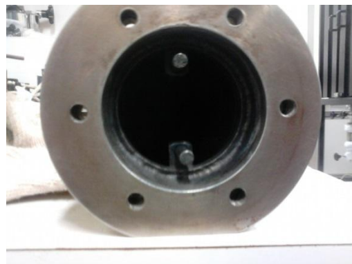
Figura 5 - Tubo de combustão com os tubos guia onde são colocadas as sondas fixa e móvel.
